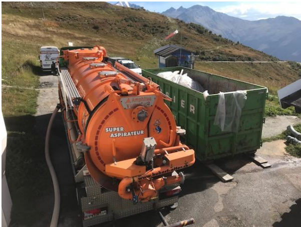
Figure 3.1 Installation à l'extérieur du camion hydrocureur et de la benne de stockage
